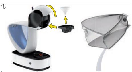
Abrir a alavanca. Puxar o porta-cápsulas para fora. Retirar o acessório de limpeza. Inserir novamente o porta-cápsulas na máquina. Se necessário, remover a água do reservatório de água.
