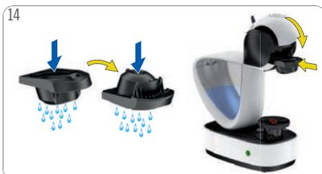
Enxaguar o porta-cápsulas (interior e exterior) com água potável. Secar o porta-cápsulas. Introduzir o porta-cápsulas na máquina. Delicie-se com a sua bebida!
