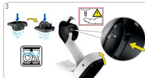
Lavar o porta-cápsulas (interior e exterior) com detergente para a loiça e água potável. O porta-cápsulas pode também ser lavado na máquina de lavar a loiça. Secar o porta-cápsulas. Limpe a cabeça da máquina em torno do injetor com um pano macio e húmido.
