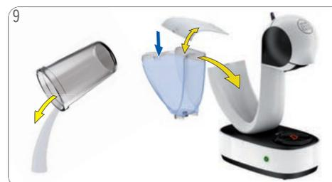
9 Despejar o recipiente. Encher novamente o reservatório de água com água potável. Instalar o reservatório na máquina.
