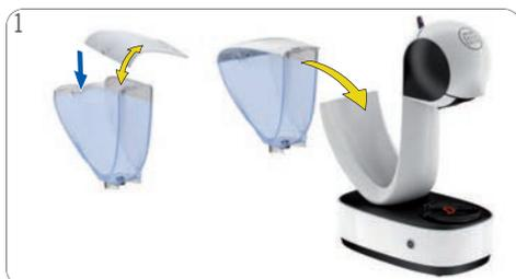
1 Enxaguar o reservatório de água com água potável. Encher novamente o reservatório de água com água potável. Instalar o reservatório na máquina.
