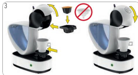
Colocar a chávena com o tamanho apropriado sobre a gaveta de recolha de pingos. Consulte o capítulo 3. «EXEMPLOS DE BEBIDAS» ou a embalagem. Abrir a alavanca. Puxar o porta-cápsulas para fora. Assegurar-se que o acessório de limpeza não está no interior. Introduzir a cápsula no porta-cápsulas. Introduzir o porta-cápsulas na máquina. Fechar a alavanca.
