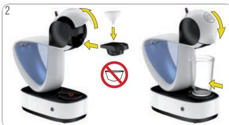
2 Abrir a alavanca. Certificar-se de que o acessório de limpeza está no porta-cápsulas e o porta-cápsulas se encontra devidamente colocado na máquina. Fechar a alavanca. Colocar um recipiente de grande capacidade sob o bico de saída do café.
