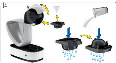
14 Abrir a alavanca. Puxar o porta-cápsulas para fora. Retirar o acessório de limpeza. Enxaguar o porta-cápsulas (interior e exterior) com água potável. Inserir novamente o porta-cápsulas na máquina.
