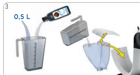
3 Misture 0,5 litro de água potável fresca com o descalcificante num copo medidor. Verter a solução descalcificante no reservatório de água e colocá-lo na máquina.
