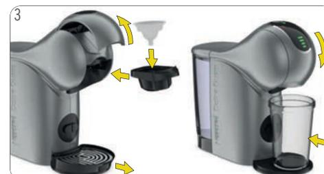
3 Abrir a alavanca. Colocar o acessório de limpeza no porta-cápsulas. Inserir o porta-cápsulas na máquina. Fechar a alavanca. Colocar um recipiente de grande capacidade sob o bico de saída do café.
