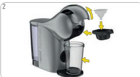
2 Abrir a alavanca. Colocar o acessório de limpeza no porta-cápsulas. Inserir o porta-cápsulas na máquina. Colocar um recipiente de grande capacidade sob o bico de saída do café.
