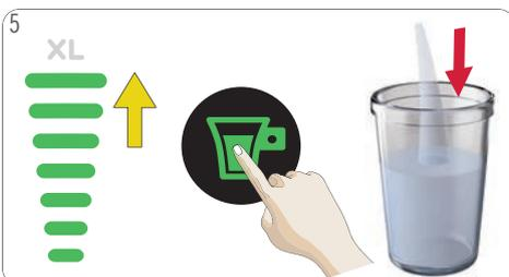
Regular o visor de barras para o nível máximo. Toque no ícone ligar/desligar. A máquina inicia o enxaguamento.
