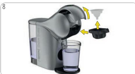
8 Abrir a alavanca. Retire o porta cápsulas da máquina. Retirar o acessório de limpeza. Inserir novamente o porta-cápsulas na máquina.
