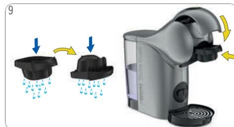
9 Enxaguar ambos os lados do porta-cápsula com água potável fresca. Secar o porta-cápsulas. Instalar o reservatório na máquina. Desfrute da sua bebida!
