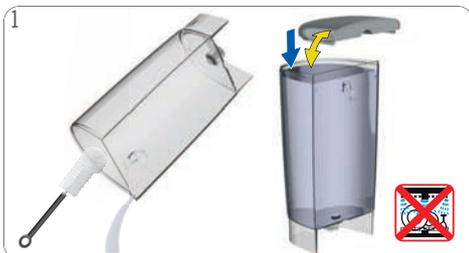
Enxaguar e lavar o reservatório de água. Utilizar uma escova limpa (para alimentos) e detergente para a loiça. Depois, encher novamente o reservatório de água com água potável e instalar o reservatório na máquina. Não lavar o reservatório de água na máquina de lavar a loiça!
