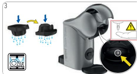
Lavar o porta-cápsulas (interior e exterior) com detergente para a loiça e água potável. O porta-cápsulas pode ser lavado na máquina de lavar a loiça. Secar o porta-cápsulas. Limpe a cabeça da máquina em torno do injetor com um pano macio e húmido.
